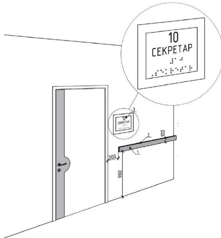
Рис. 38 Приклад розміщення тактильних інформаційних позначок приміщень: 1- інформаційна направляюча, 2- тактильна інформаційна позначка, 3- інформаційна тактильна табличка, що дублює текстову інформацію у тактильному вигляді плоско друкованого тексту та шрифтом Брайля.
